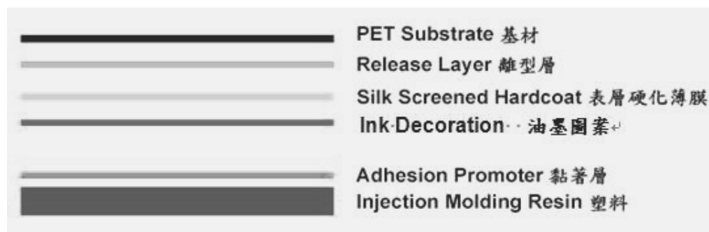
【圖 1、IMR 薄膜構成圖】
