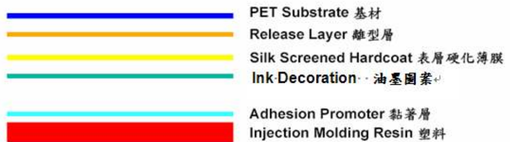
【圖 1、IMR 薄膜構成圖】
