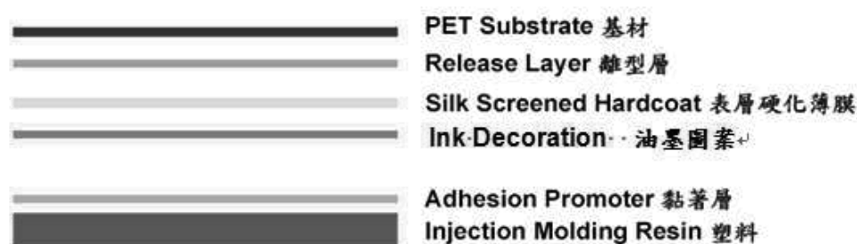
圖 1 IMR 薄膜構成圖
