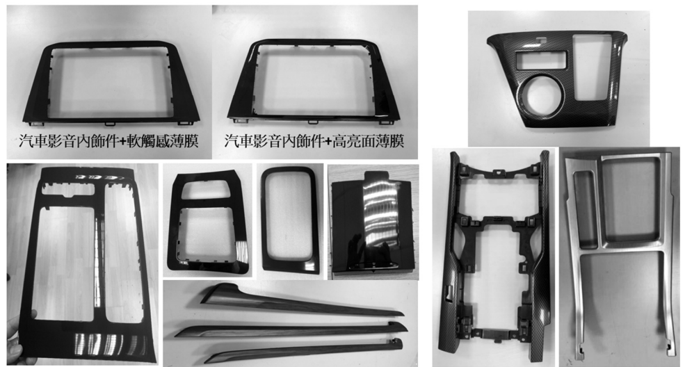
圖 7. 測試中的汽車內飾件 (影音系統/中控/置物架)
