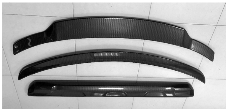
圖 8. 測試中汽車外飾件空氣動力套件
