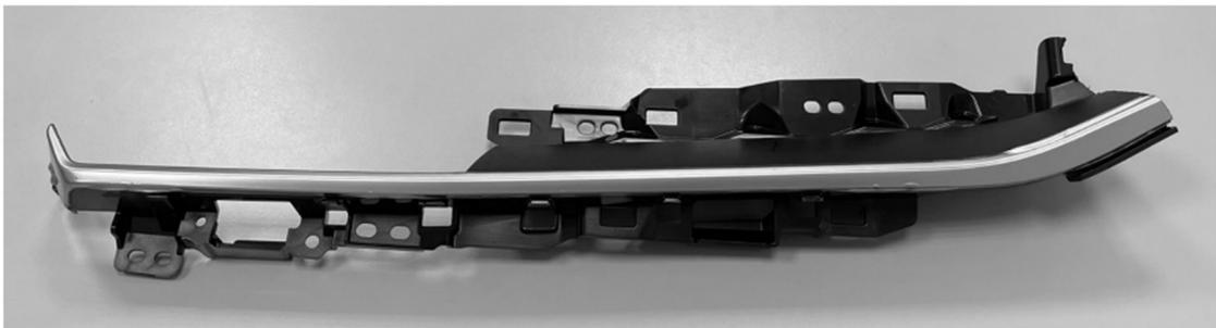
圖 7. 量產中汽車中控邊框內飾件
