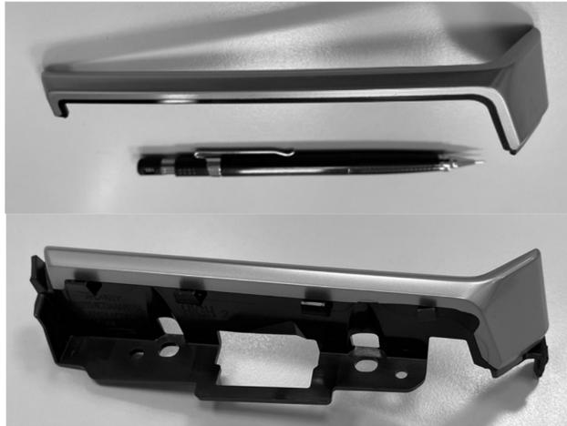
圖 6. 量產中汽車冷氣邊框內飾件產品
